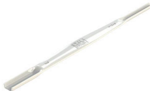
Mit dem Micro-Spatel können kleine Chemikalienmengen, Pulver, Granulate, Pasten, Cremes oder Flüssigkeiten beprobt, umgefüllt oder verarbeitet werden. Inhalt 1,0 und 0,25 ml, Spatelbreite auf der einen Seite 11 mm, auf der anderen 5,7 mm. Der stabile und handliche Mittelgriff erleichtert ein präzises Arbeiten.
