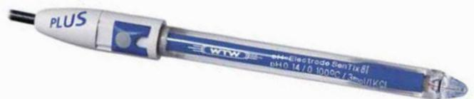
Standard pH-Einstabmesskette mit Glasschäft, Flüssigelektrolyt. Mit 1 m Festkabel.
